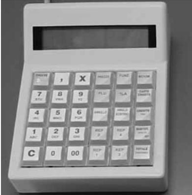
Per questa particolare configurazione è prevista la possibilità di connettere all'apparecchio un tipo di tastiera ridotta da 30 tasti completa di display operatore con le medesime caratteristiche del modello 64 tasti (vedi foto al paragrafo successivo). In questa tastiera le funzioni sono ridotte ai comandi essenziali ed hanno caratteristiche medesime a quelle estese già illustrate nel Capitolo precedente.
