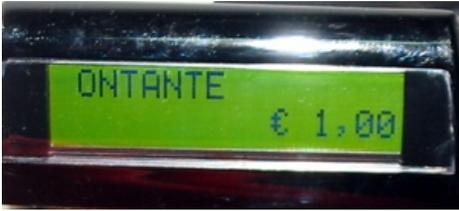
Il *prodotto* è provvisto di un display cliente a **torretta esterna** contenente un indicatore tipo LCD *alfanumerico e retro illuminato* con due linee da 16 caratteri ciascuna.
